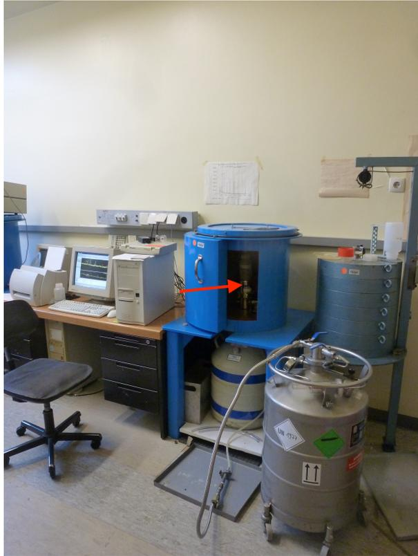
Abbildung 2.9: Abbildung des verwendeten Gammadetektors.
