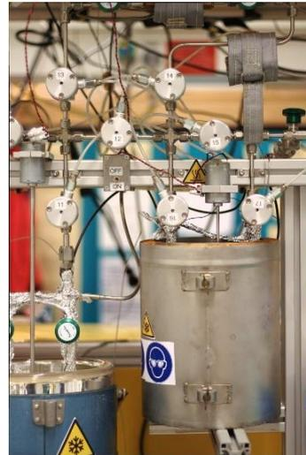
Ausschnitt aus der fertiggestellten Gasaufbereitungsanlage zur Extraktion der Kryptonfraktion.
