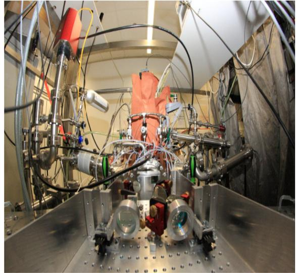
Foto: Blick auf einen Teil der Ultrahochvakuumkammern des ATTA-Experiments.
