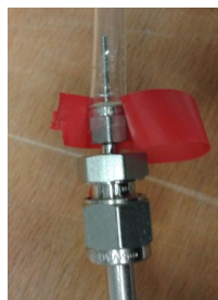
Abbildung 8.1: Verbindung des Argonbeutel mit der Mutter der Fitting-Verbindung, in der die Metallkapillare eingezogen ist.
